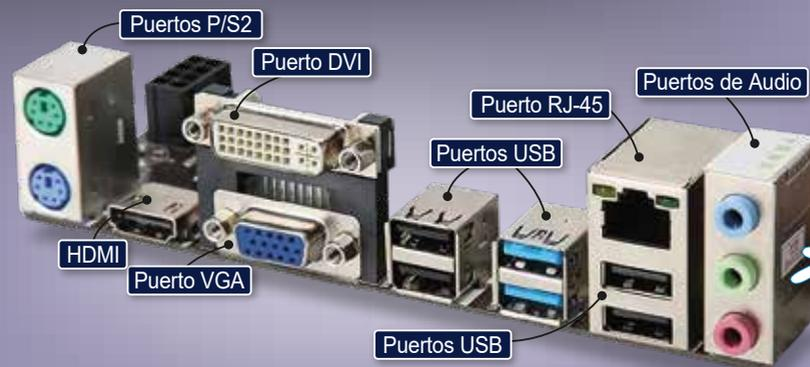
La comunicación de las computadoras con los dispositivos periféricos de entrada y salida se realiza mediante los puertos (ports) de comunicaciones. Se encuentran en la parte trasera de las computadoras.
